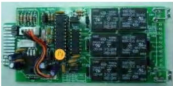
Fig. 8-3-5 – 1 Contatto relè scheda plug-in (scheda DCE-B)
