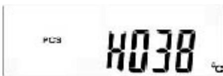
Fig. 7-4 – 3 Visualizzazione I – Temperatura dissipatore °C
