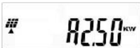
Fig. 7-4 – 10 Visualizzazione P – Potenza di uscita stringa A
