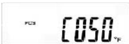
Fig. 7-4 – 4 Visualizzazione J – Inverter fotovoltaico Temperatura interna °F
