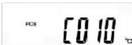
Fig. 7-4 – 2 Visualizzazione H – Inverter fotovoltaico Temperatura interna °C
