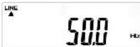
Fig. 7-4 – 13 Visualizzazione S – Frequenza dell'inverter fotovoltaico tensione di uscita
